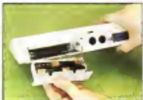
Il minifloppy per il minicomputer è inserito nel vano batterie del FP-200.
